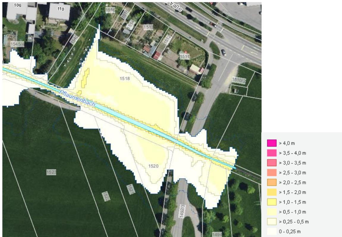
Abbildung 2: Hochwassergefahrenkarte für den Bereich des Baugebietes (Quelle: Daten- und Kartendienst der LUBW - UDO)
