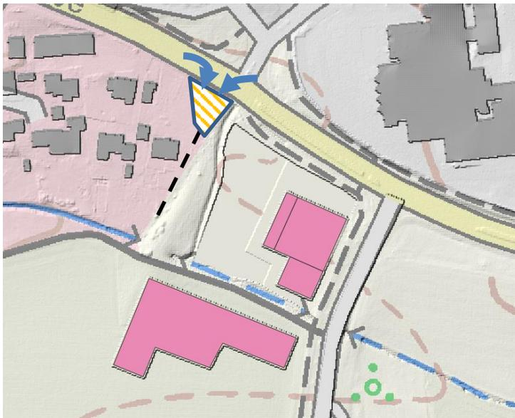
Abbildung 8: Trichterförmige Einlaufstruktur (orange gestreift) und Entwässerungsgraben (schwarz), Fließrichtung (blau)
