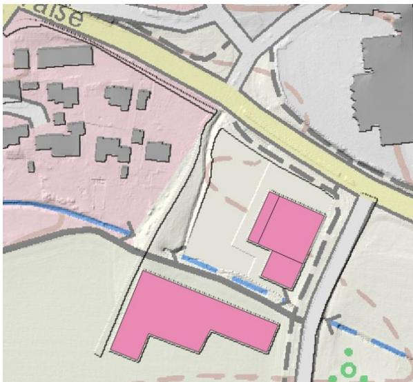
Abbildung 7: Digitales Geländemodell Szenario 2 mit zusätzlichem Schutzwall entlang der Bühlerstraße
