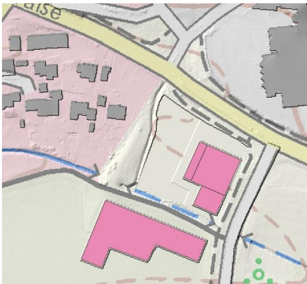
Abbildung 6: Digitales Geländemodell zu Szenario 1 mit Erhöhung der Straße „An den Wasenwiesen“ um Retentionsvolumen westlich zu schaffen und der Geländemodifikation an der Schule
