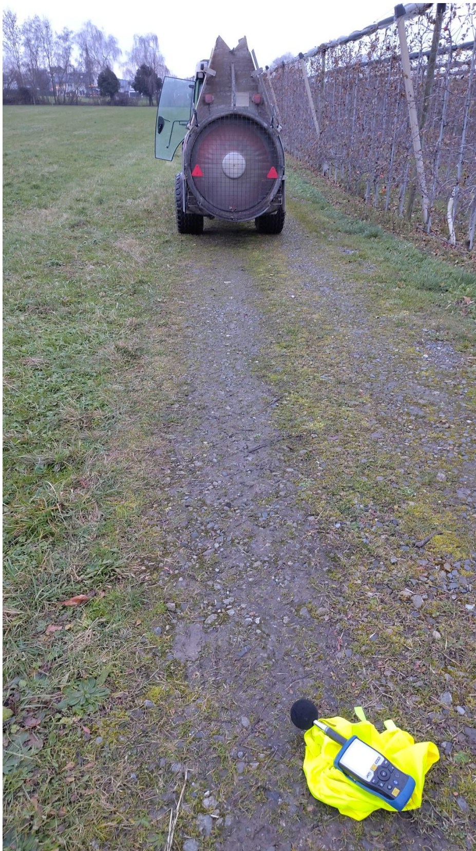
Bild 8: Messung der Gebläsespritze im Stand in Achsverlängerung hinter dem Fahrzeug
