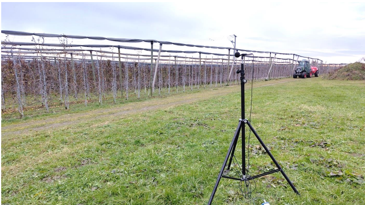
Bild 6: Messung der Vorbeifahrpegel (Messungen 3)
