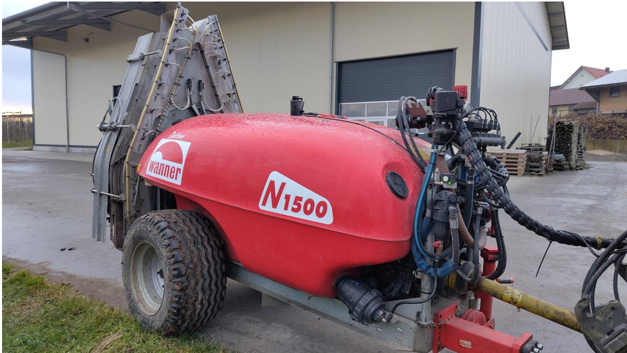
Bild 5: Anhänger mit Gebläsespritze (Axialgebläse der Firma Wanner Typ 42GA)
