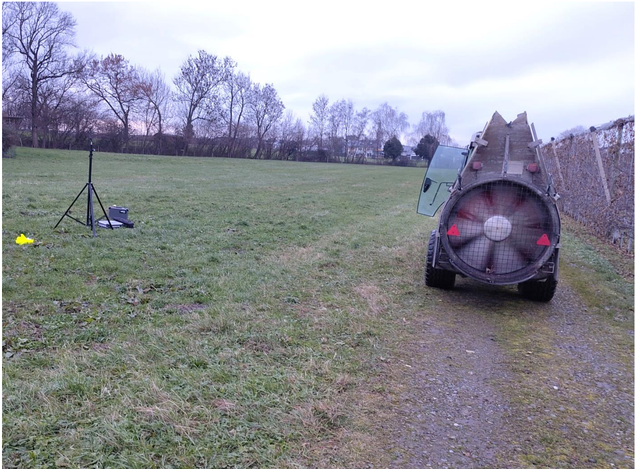
Bild 7: Messung der Gebläsespritze im Stand (links zur Fahrtrichtung = Messungen 4)
