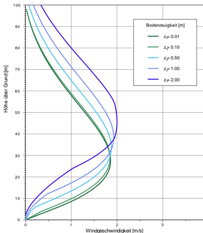
Abbildung 6-2: Typische Kaltluftabflussprofile für unterschiedliche Rauigkeiten
