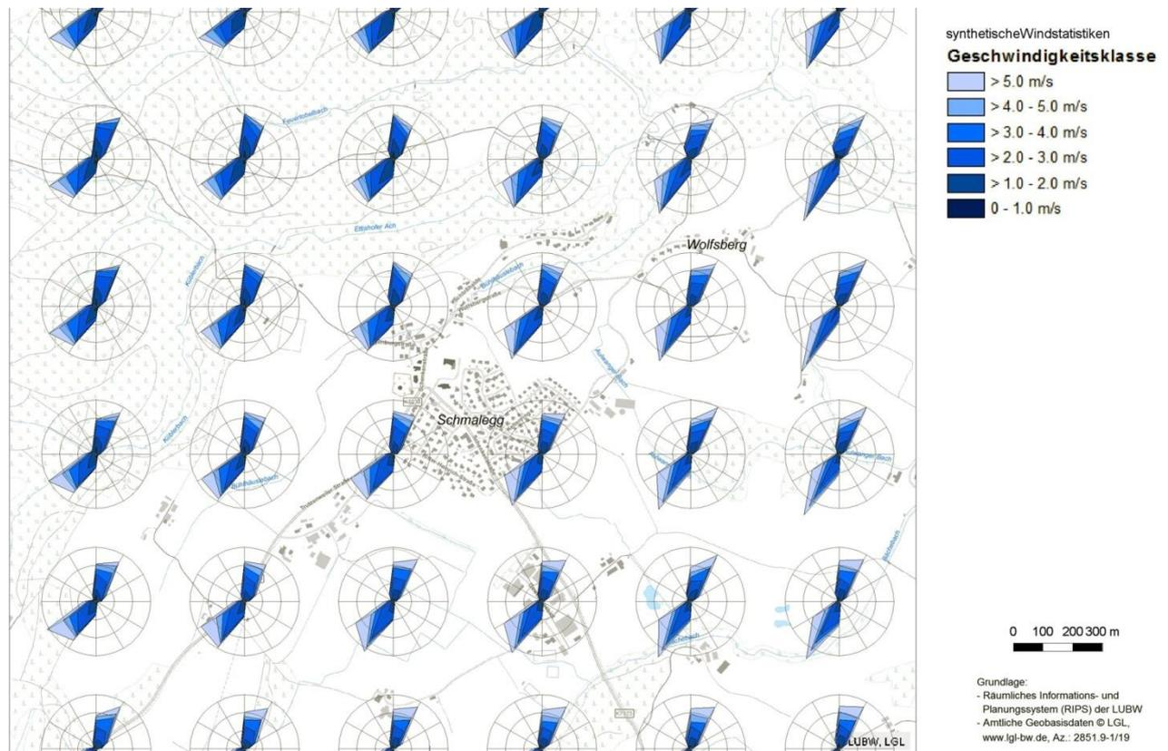
Abbildung 5-1: Synthetische Häufigkeitsverteilungen der Windrichtungen im Raum Schmalegg (Quelle: LUBW).
