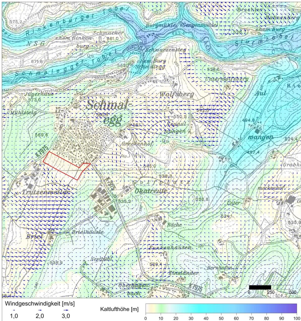
Abbildung 11-3: Windgeschwindigkeit in 2 m über Grund und Kaltluflhöhe für den Planfall **eine Stunde nach Einsetzen der Kaltluftabflüsse**
