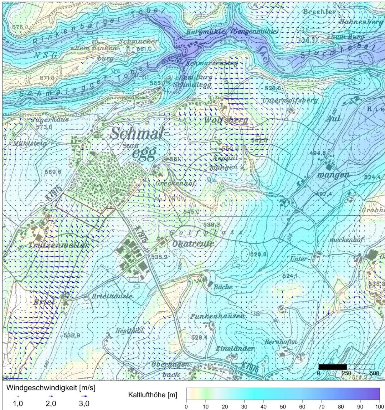
Abbildung 11-4: Windgeschwindigkeit in 2 m über Grund und Kaltluflhöhe für den Istzustand **drei Stunden nach Einsetzen der Kaltluftabflüsse**
